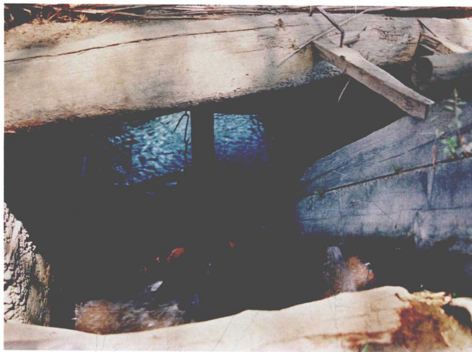
水磨叶轮依靠渠水动力推动
