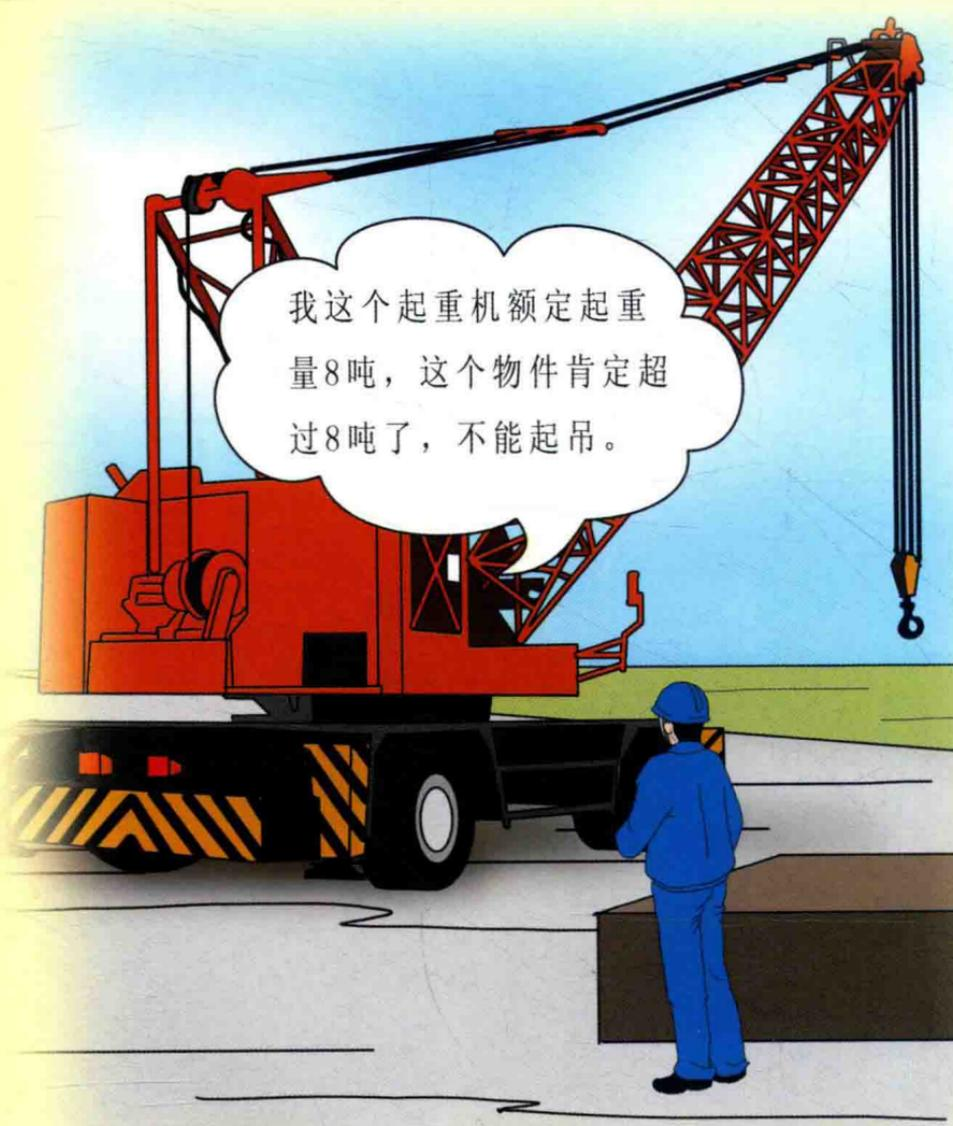
我这个起重机额定起重量8吨，这个物件肯定超过8吨了，不能起吊。
