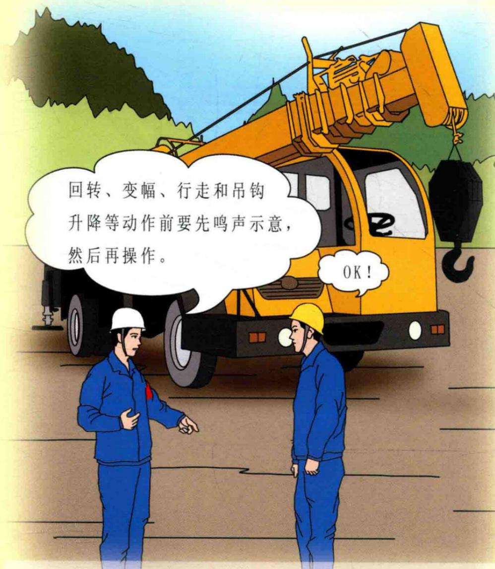
10. 起重司机在进行起重机回转、变幅、行走和吊钩升降等动作前应先鸣声示意，然后再进行操作。
