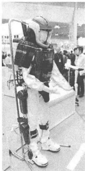
图 1-2 日本一家公司研发的用于核辐射和酷暑环境的机器人
