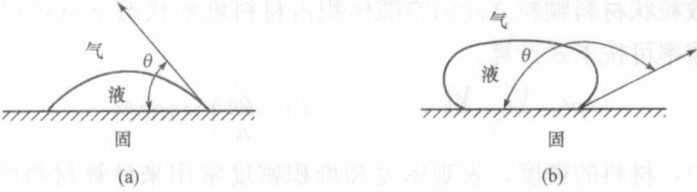
图 1-1 材料的浸润示意图
