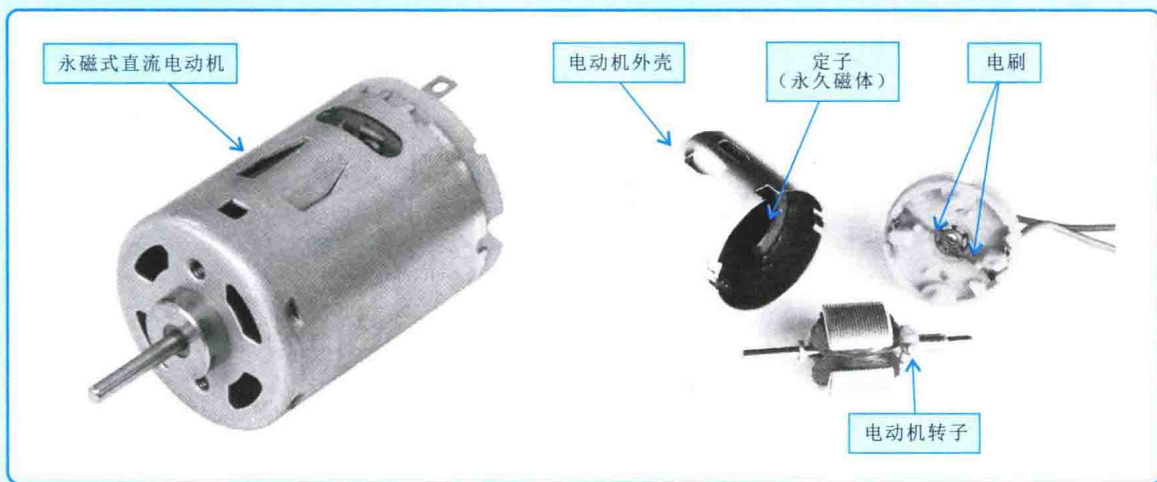
【永磁式直流电动机的结构】
