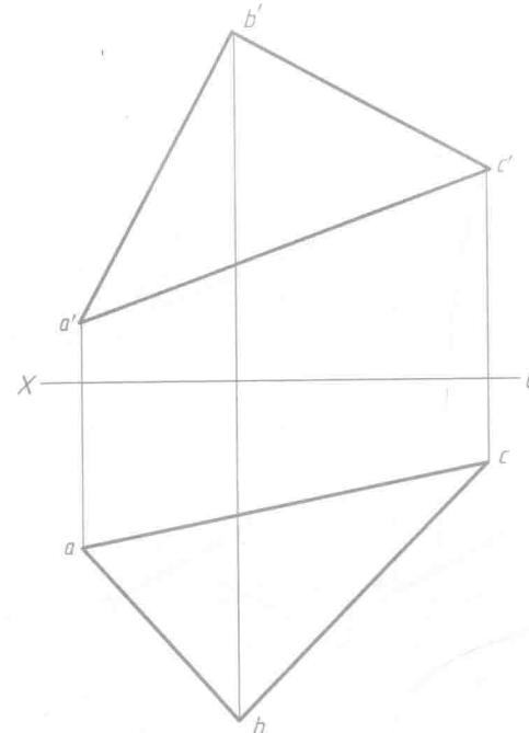
4-12 球 M 从斜坡 ABCD 上滚下, 作出它的轨迹的投影, 并求出斜坡对 H 面的倾角  $\alpha$ 。
