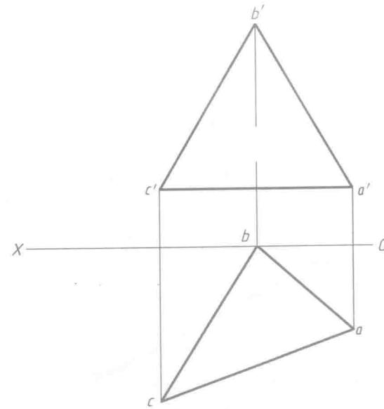
5-10 已知  $CD$  为  $\triangle ABC$  平面内的正平线， $\triangle ABC$  对  $V$  面的倾角  $\beta=30^\circ$ ，求作  $a'$ 。
