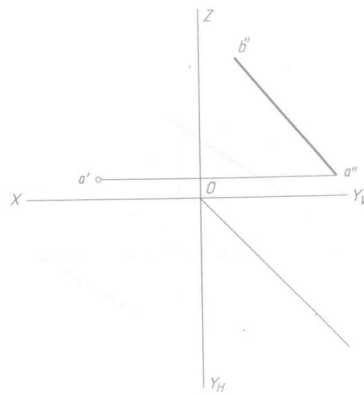
3-14 已知直线AB的投影 $a'b'$ 和 $a$ , 倾角 $\beta = 30^\circ$ , 试完成它的投影。
