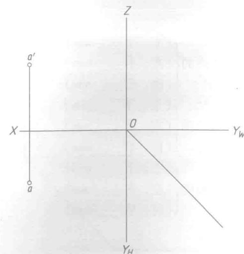
3-5 已知  $CD$  为侧平线,  $\alpha = \beta$ , 实长为  $20mm$ , 试完成它的三面投影。
