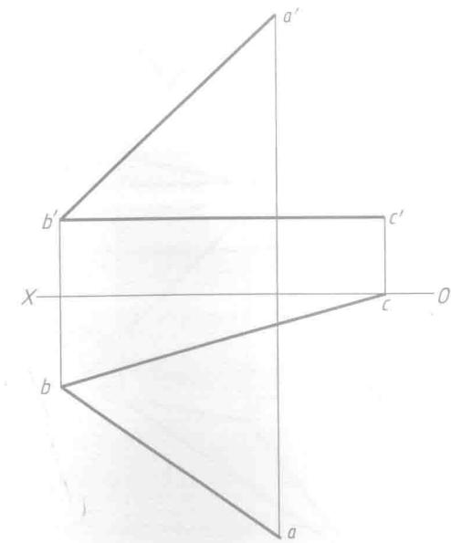
5-1 作出 A、B 点在  $H_1/V$  中的投影。
