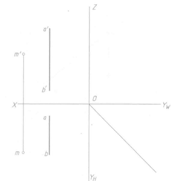
3-26 已知 B 点距 V 面 20mm，以正平线 AC 为对角线作一正方形 ABCD。
