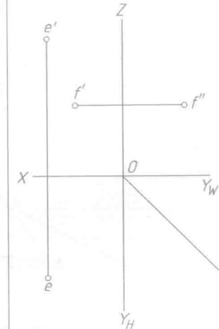
2-4 已知 A、B、C 三点在轴测图中的位置，作出它们的投影图（从轴测图上量取坐标，并写出各点的坐标值）。
