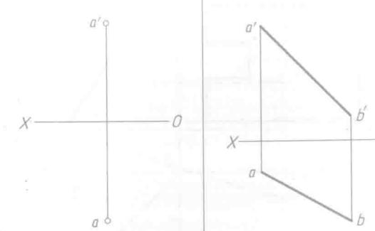
4-8 已知正方形 ABCD 的一条对角线 AC 为水平线, 试完成其 V 面投影。
