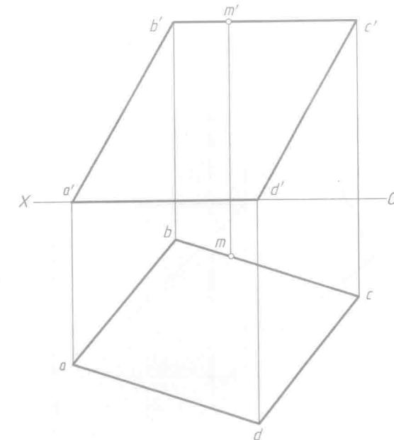
4-13 在平面 ABC 内求作一点 M, 使其距 V 面 15mm, 距 H 面 20mm。
