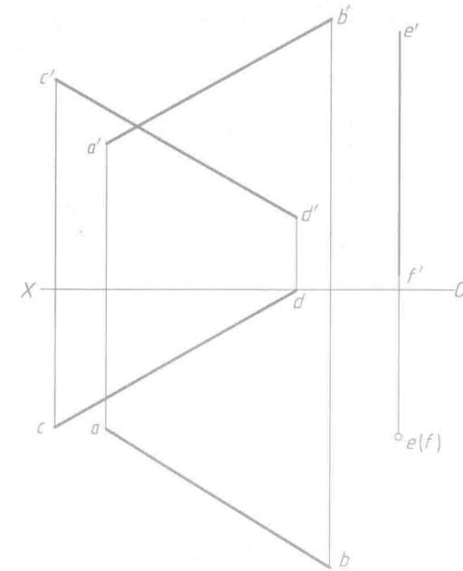
3-20 侧平线 CD 与 AB 相交,  $Y_d < Y_c$ ,  $CD$  的  $\alpha = 60^\circ$ , 求作  $CD$  的三面投影。
