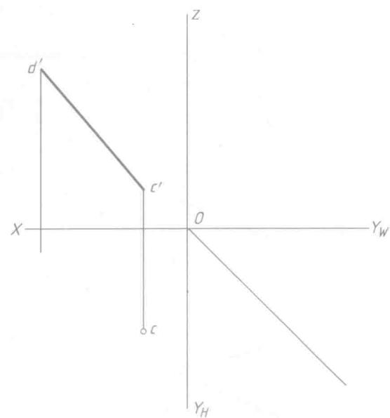
3-13 已知直线AB的投影 $a''b''$ 和 $a'$ , 倾角 $\gamma = 30^\circ$ , 试完成它的投影。
