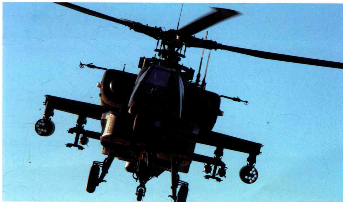
美国 AH-64 武装直升机，机身左右最外侧配备的武器是 19 管 M261 火蛇 70 航空火箭弹发射器。
