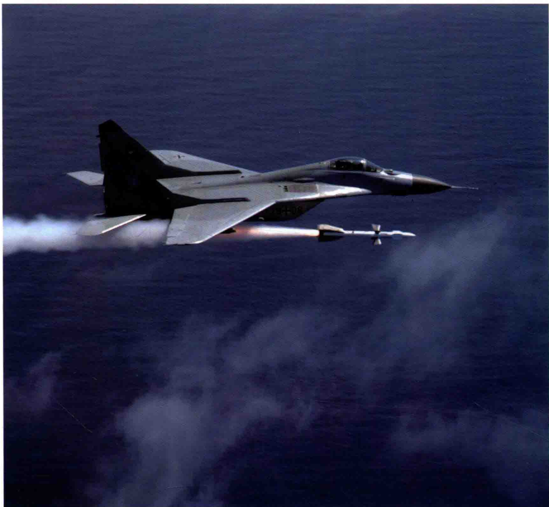
俄罗斯的米格-29战斗机，机翼下可挂载6枚空对空导弹。图为发射AA-10空对空导弹瞬间。
