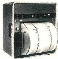
图11.1-6 绘制地震曲线的装置
