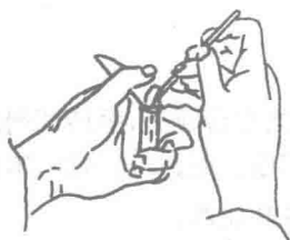
图实1—2 用倾泻法将沉淀和 溶液分离
