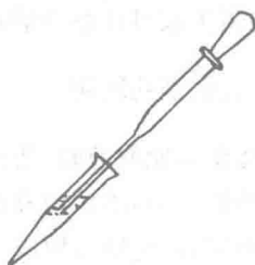
图实1—3 用吸出法将沉淀和溶液分 离
