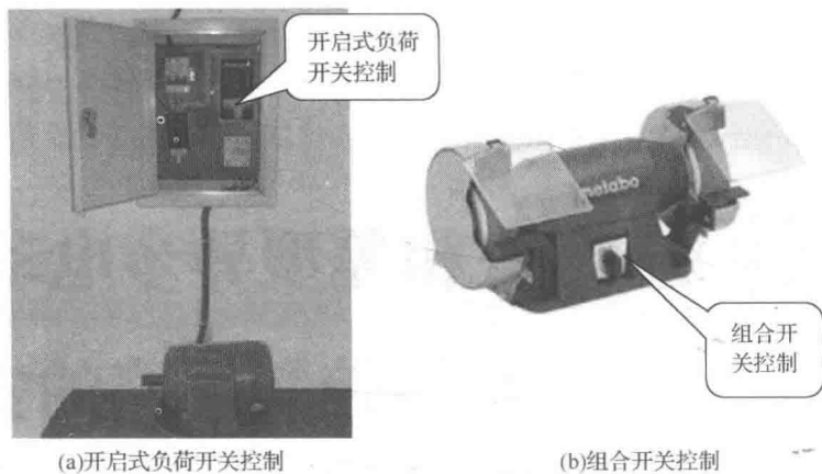
图 1-1-1 三相笼型异步电动机的手动正转控制
