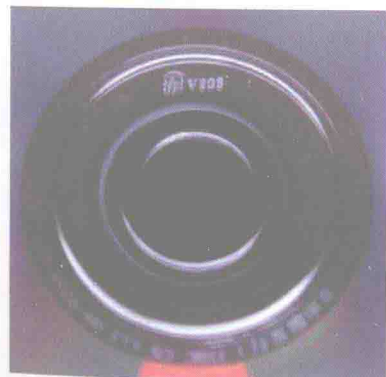
图7 伪造SID码的光盘
