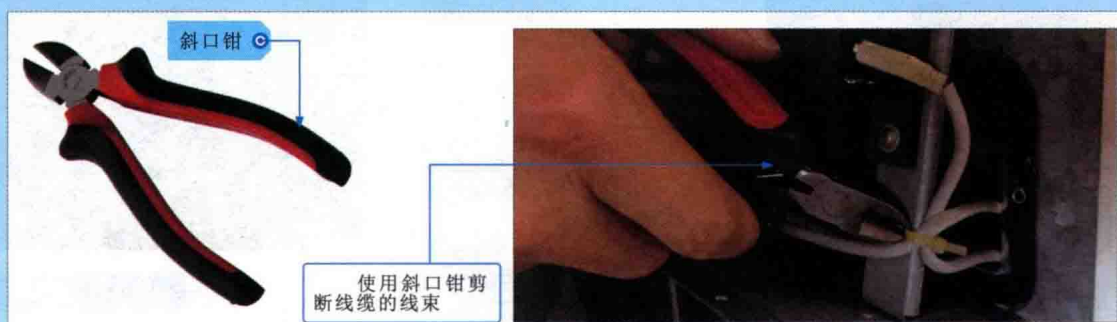
图1-3 斜口钳的使用方法
