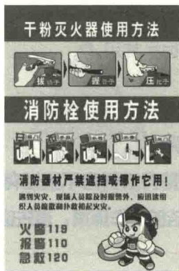
图1-14 灭火器及消防栓的使用方法
