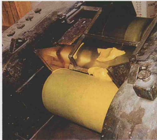
在颜料生产过程中，生产商用机器带动的磨坊，加入油研磨色料，制成油画颜料
