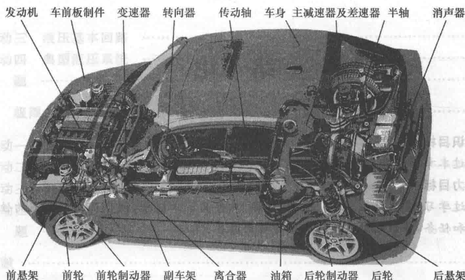
图 0-1 典型轿车总体结构
