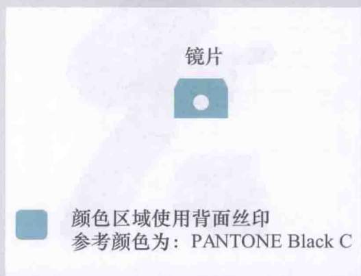
▶ 图 7-4 镜片丝印图
