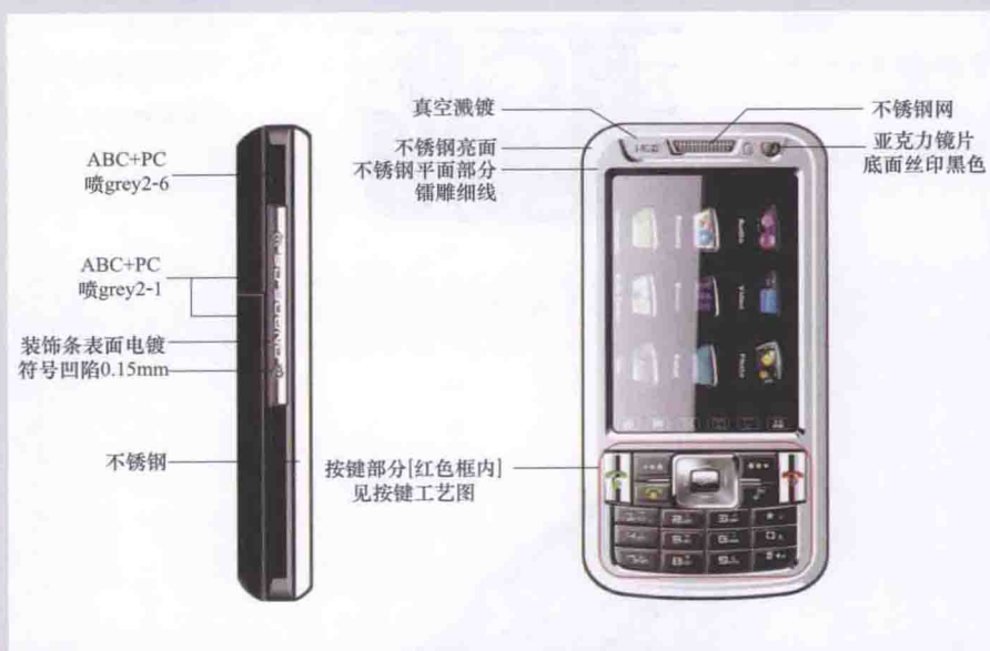
► 图 5-11 直板手机效果图表面处理方案 1
