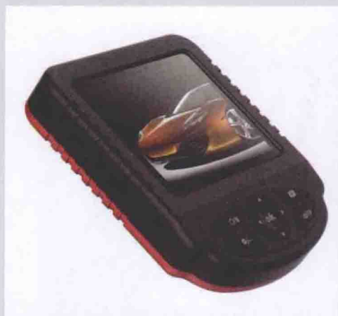
▶ 图 11-18 车载内窥镜显示屏组件
