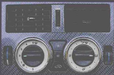
メルセデスとしては新鮮なカーボンパネルを使ったセンターコンソール。エアコンは、左右独立温度調整のダイヤル式が採用されている。
