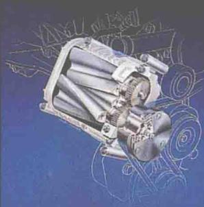
強力なSLKに積まれる2.3Lコンプレッサー・ユニット。193HP、28.6kg-mというハイパワーを発揮する。コンプレッサー（＝スーパーチャージャー、右図）はイートン製でインタークーラーも備わる。
