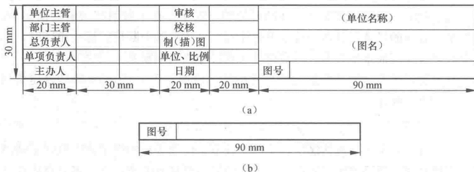
图 1-2 通信工程勘察设计常用图衔
