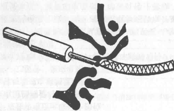
图 1-13 金属编织线法拆卸元件示意图
