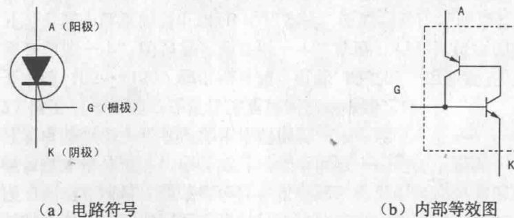
图 1-14 可控硅电路应用符号及内部等效图
