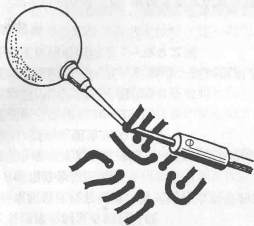
图 1-12 吸球吸锡拆卸法拆卸元件示意图
