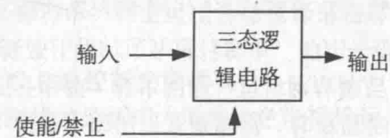
图 1-9 三态逻辑电路示意图
