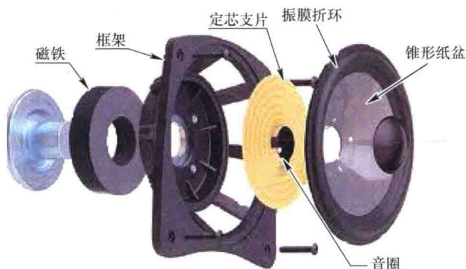
图2 扬声器结构图2
