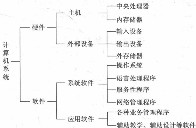
图 1-1 计算机系统的组成
