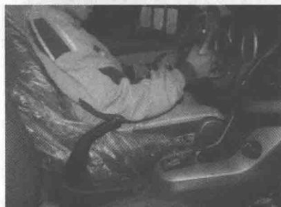
图 1-9 检查变速杆及驻车制动杆
