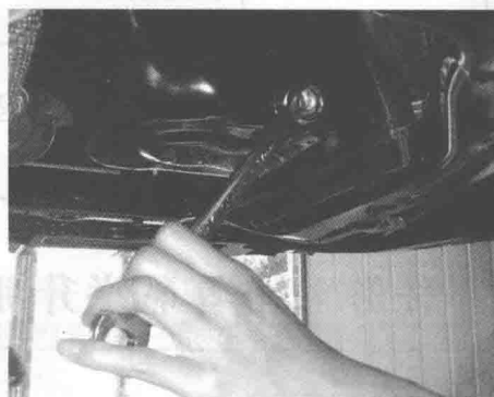
图 1-14 勿戴手套排放机油
