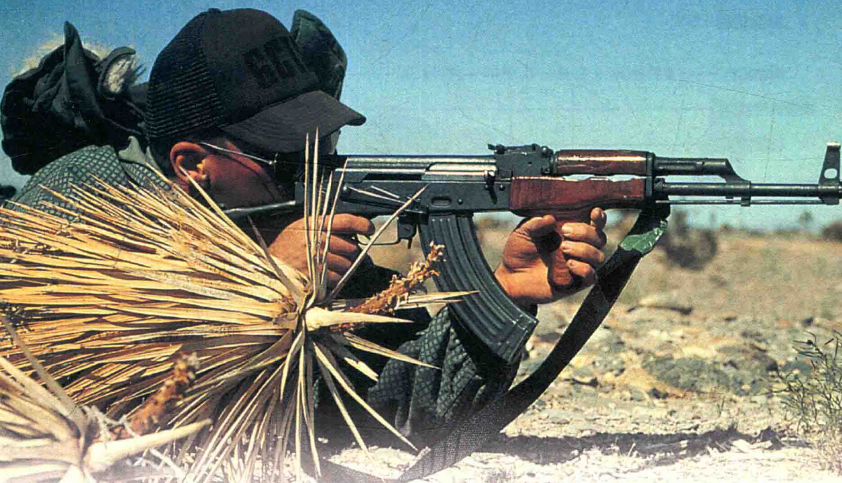
上图：著名的 AK-47 突击步枪，它是 AKM 的前身。两者之间的差异是 AKM 的枪机锁在套管里，而不是直接锁在枪管里。
