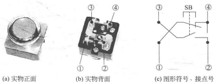
图 1-11 按钮实物接点编号及图形符号
