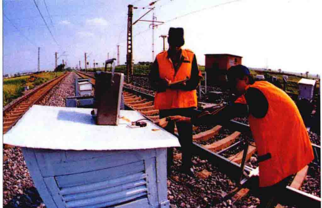
▲ 货车列检所使用红外线轴温探测仪
