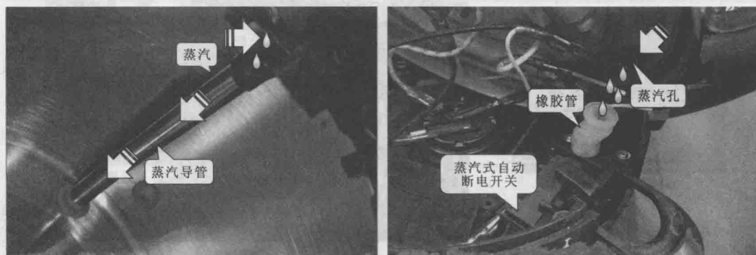
图 1-8 蒸汽式自动断电开关的工作原理
