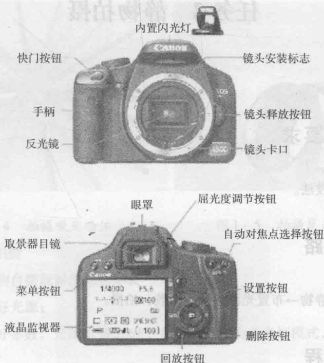
图 1-3 数码相机功能示意
