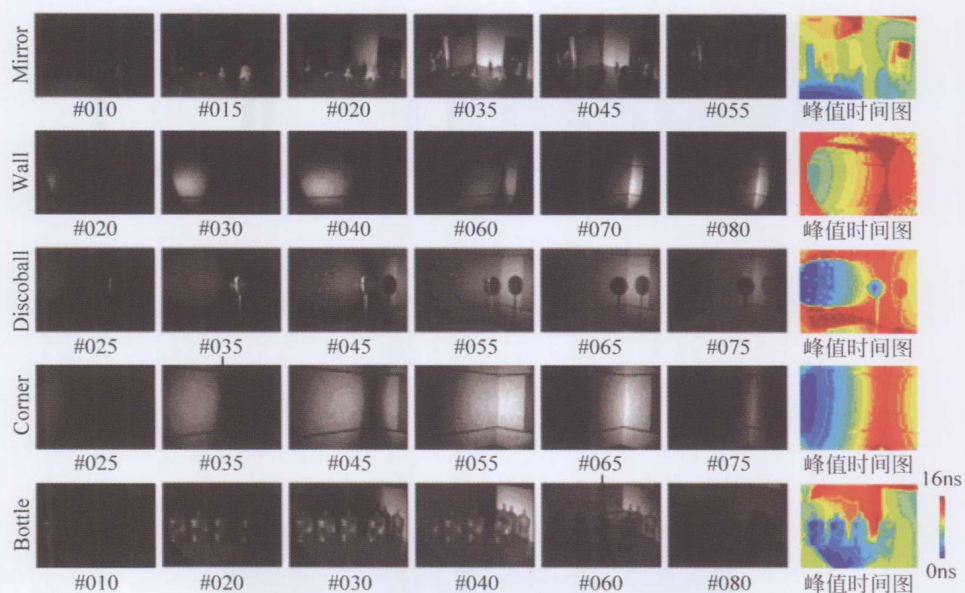
图 6.54 由文献 [503] 的真实数据 (五组) 重构的暂态图像的若干帧 (每一行对应一组数据, 时间分辨率为 0.33\text{ns} )
