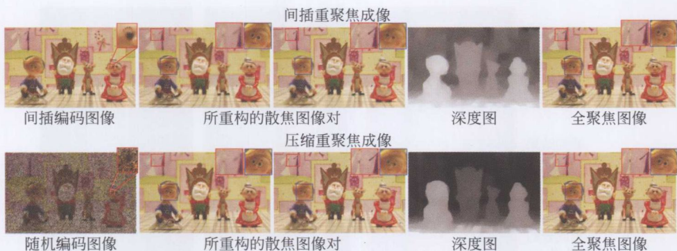
图 4.20 实采数据合成调制实验。顶行显示了间插重聚焦成像的结果，底行给出了压缩采样重聚焦图像结果。高亮图像框表明，相比于间插重聚焦成像，压缩重聚焦成像能够提供更高的空间分辨率并获取更准确的深度和全聚焦图像估计
