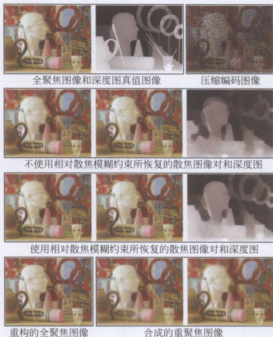
图 4.19 “Art”数据集的仿真重构。本方法从真值的全聚焦图像和深度图中合成出散焦图像对，然后设计对应的两个随机调制掩膜，从散焦图像对中合成编码图像。在上面的图示中说明了采用以及未采用相对散焦模糊约束所恢复出的散焦图像对和深度图，以此可以恢复全聚焦图像并可以合成重聚焦图像序列
