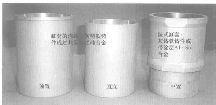
图 4.5-5 用于浇铸在压铸件中的不同的气缸孔摩擦面的形式（上）以及用于热套装及插入式的缸套（下）；插入式湿缸套（右下）
