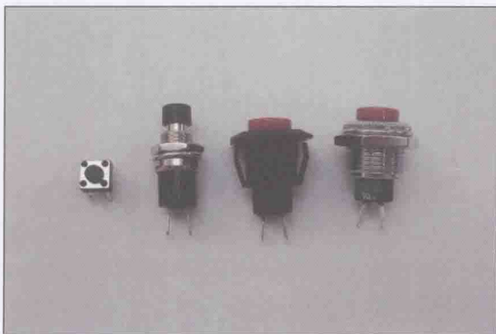
图 1-9 轻触按钮（左）和三个不同的面板安装按钮（右）
