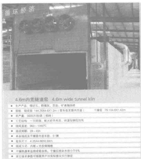
图 1-5 4.6m 内宽隧道窑
