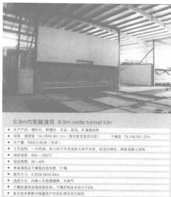
图 1-3 6.9m 内宽隧道窑
