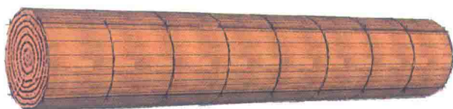
彩图 31 西山南平柱头铺作斗的加工方式
