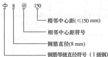
图 1-2 钢筋的尺寸标注(二)
