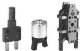
图 1-7 机器人手爪的例子。从左至右依次是双指平行夹持器、剪刀型夹持器以及垂直手爪(图片来源:ASG-Jergen's, 俄亥俄州,克利夫兰市)
