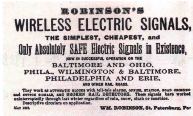
图 1-2 鲁滨孙宣传轨道电路能够检查断轨的广告明信片
