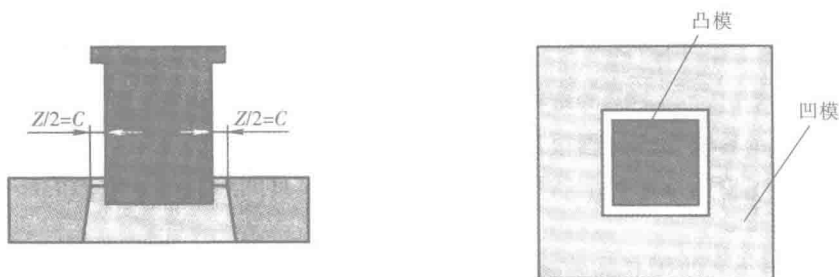
图 1.1.10 冲裁间隙
