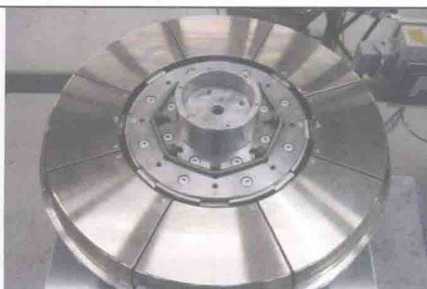
安装在主机上的瓣式轮辋
