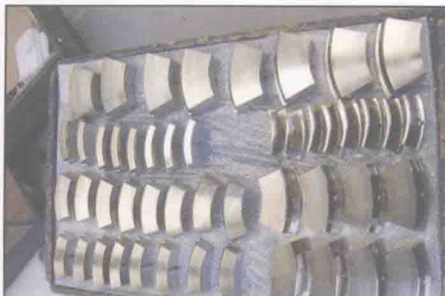
符合WDK116标准的高精度分瓣式轮辋
