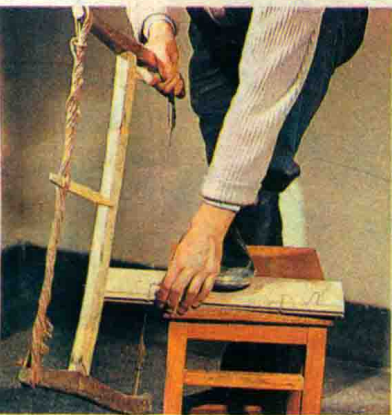
7锯 锯条应与木板成45°角。钢丝锯齿应向前方。
