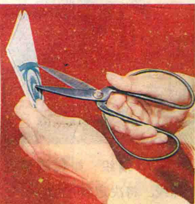
4剪 剪纸及铁皮。右手持剪行剪，左手持纸迎剪。
