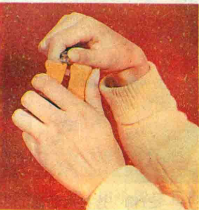
10切削 泥可用泥篦、线弓切，竹木只宜用刀削。
