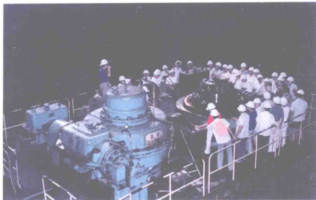
现场指导安装太钢 1200 轧钢机传动副(1)
