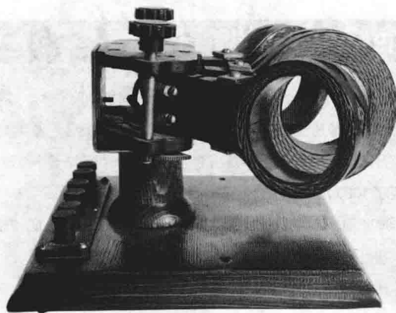
图3 线圈耦合调感式矿石机
