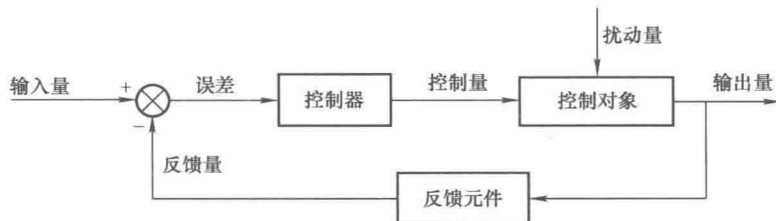
图 1-8 闭环控制系统的典型结构框图
