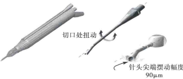
图 1-1-6 扭动模式 OZil 扭动超声手柄,Torsional 针头
