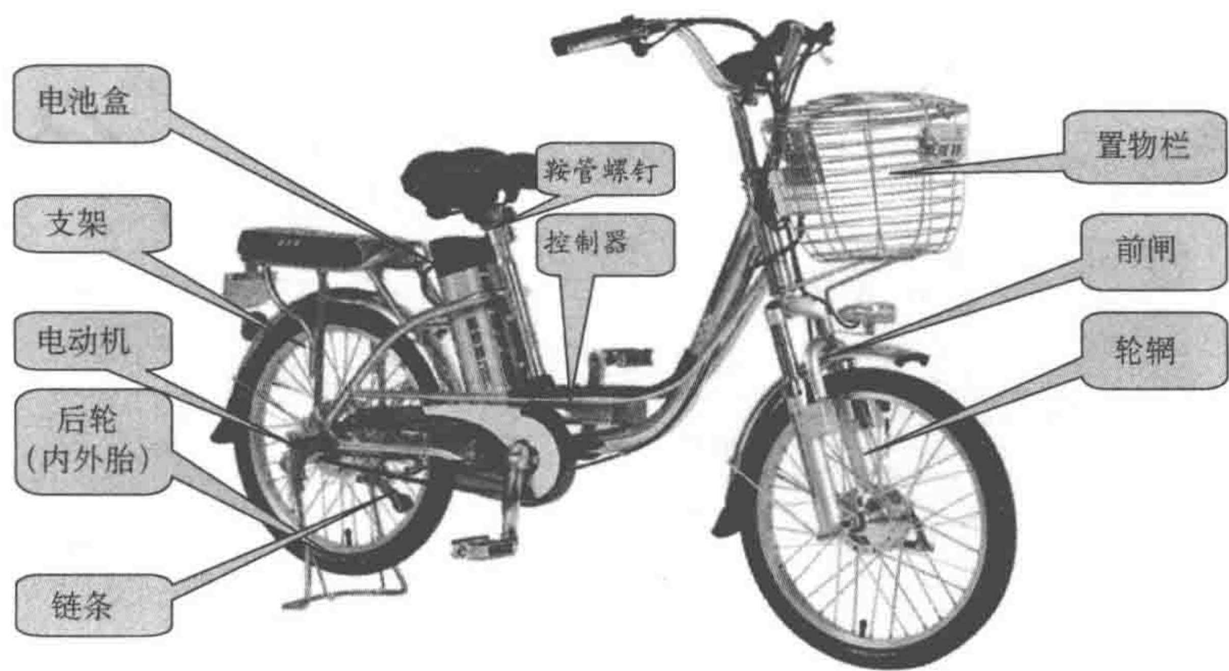
(a)简易型电动自行车的组成
