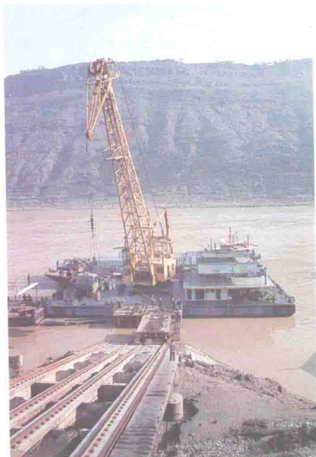
涪陵荔枝园码头。 大件自动移位船与缆 车协同作业
