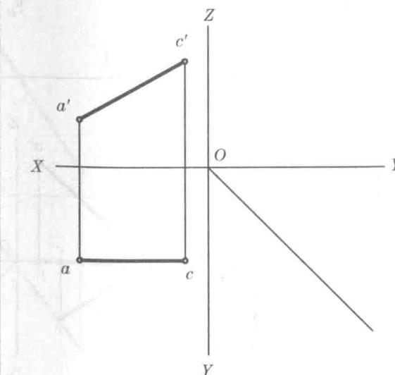
8. 设P平面对H面的最大坡度线为MN, 求作P平面内的正平线AB, 使其距V面为20。
