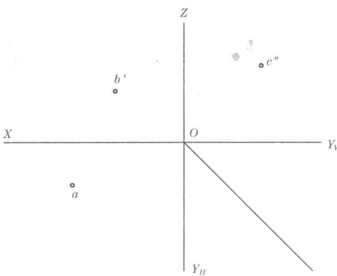
5. 设 $B$ 点在 $A$ 点的右方20、前方10、上方15。作出 $B$ 点的三面投影，并将 $B$ 点的坐标填在括号内， $B( )$ 。
