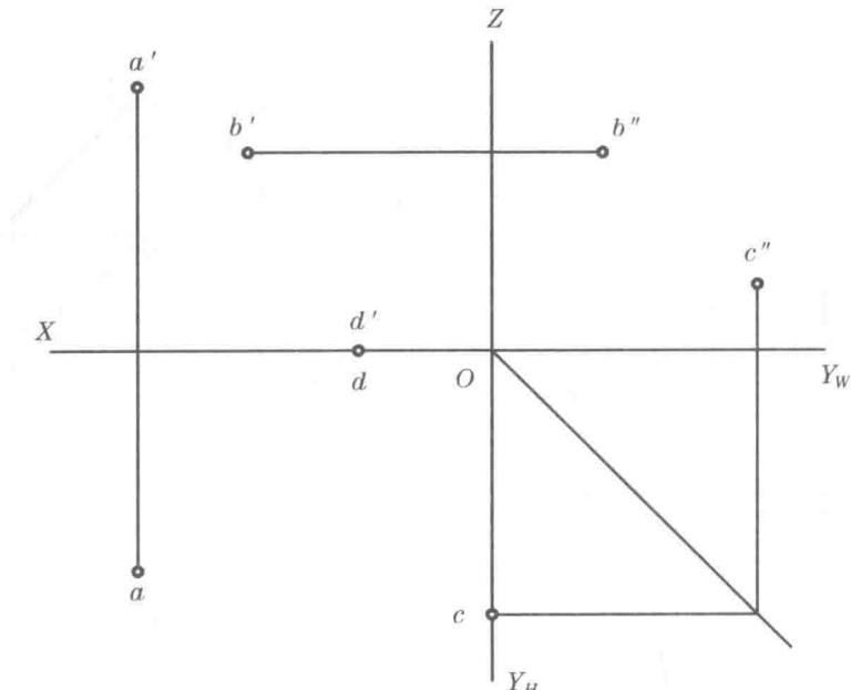
4. 已知 $A$ 点在 $H$ 面之上25,  $B$ 点在 $V$ 面之前30,  $C$ 点在 $W$ 面之左35, 补全诸点的三面投影。
