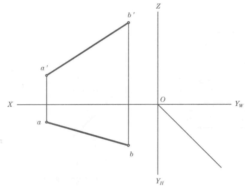
3. 设正平线AB距V面为10, B点在A点右上方,  $\alpha=30^\circ$ , 实长30; 铅垂线CD距W面为5, D点在C点下方, 实长为20。作AB和CD的三面投影。
