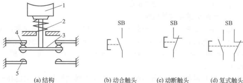
图 2-6 控制按钮的结构与图形符号
