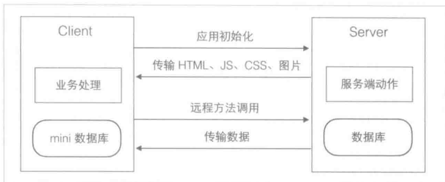
图 1.4 Meteor 中客户端和服务端的工作流程
