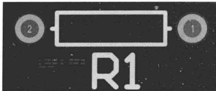
图 1.4 DXP 软件中直插色环电阻的封装
