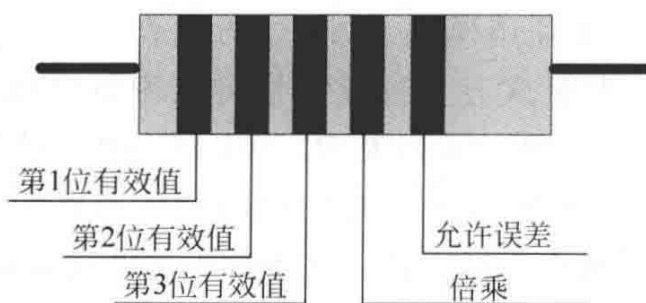
图 1.1 五道色环电阻示意图
