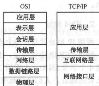
图 1-4 TCP/IP 网络体系结构与 OSI 网络参考模型的对比
