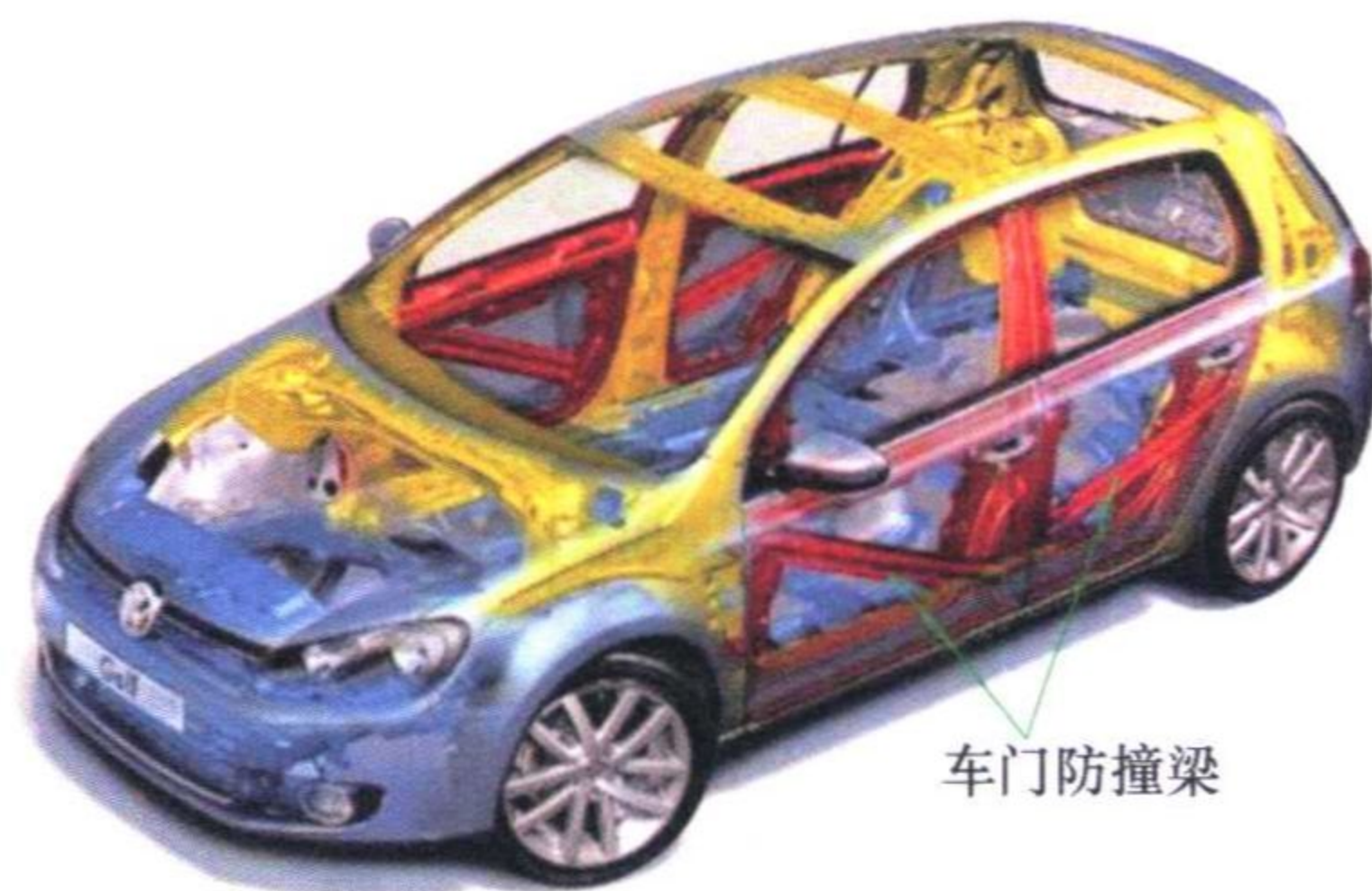
图 1-28 车门防撞梁示意图
