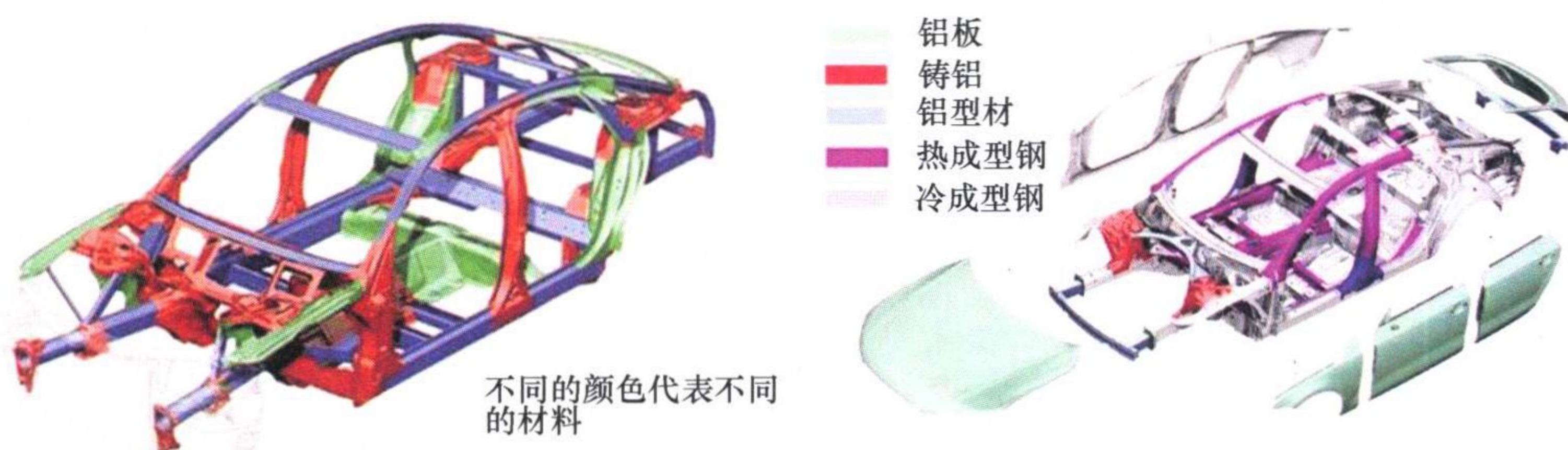
图 1-27 车身材料结构示意图
