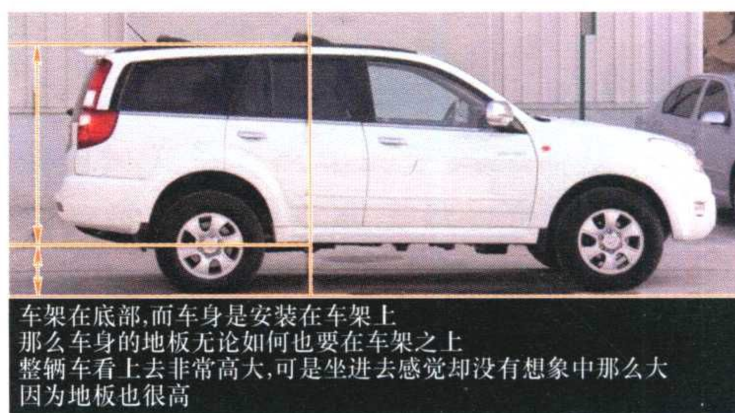
图 1-24 非承载式车身结构的专业越野车
